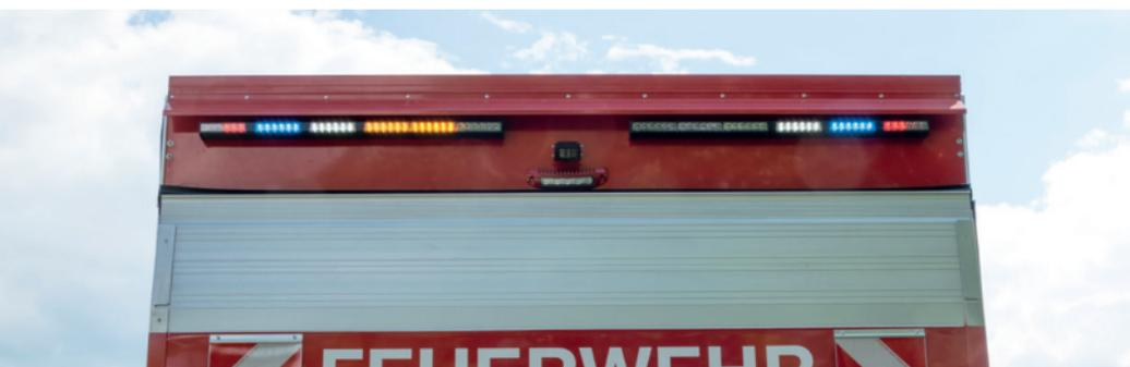
Geteiltes Heckwarnsystem wahlweise mit 2 blauen Heckblitzern, Schlusslicht, Bremslicht, Fahrtrichtungsanzeigern und Retourscheinwerfern, jedes Module mit 6x 3W-LEDs. Das System garantiert optimale und wirtschaftliche Absicherung des Einsatzortes.
