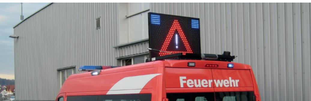
Funkferngesteuertes, motorisch klappbares LED-Panel zur Absicherung des Einsatzortes bereits über größte Entfernungen hinweg. Für Polizei, Feuerwehr, Straßendienst u. a.
