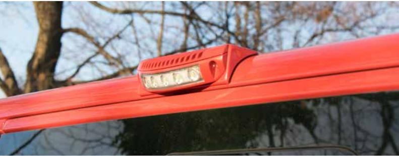
GFK-Aufbaukonsolen für SCENELITE SI7 LED-Umfeldbeleuchtungen zur seitlichen oder heckseitigen Montage am VW T5 und T6 Fahrzeugdach. Kundenseitig auch für andere Fahrzeugmodelle mit ähnlicher Dachrandausbildung anpassbar.
