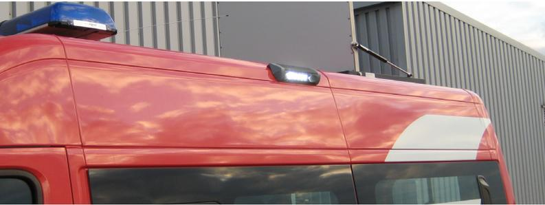
LED-Umfeldbeleuchtung mit 6x 2,5W Cree-LEDs. Ihre Leistung ist zu vergleichen mit 55W Halogen-Licht.
